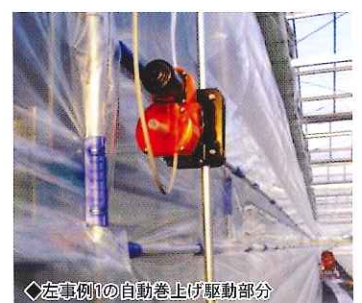
◆左事例1の自動巻上げ駆動部分
